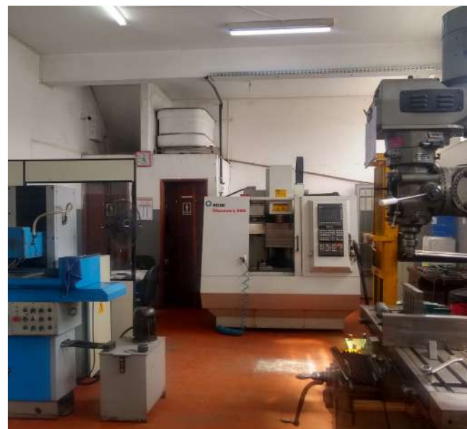
IMAGEM 4: Pequena fábrica de peças da cidade de São Paulo. Fresadora no primeiro plano, no canto esquerdo uma retífica de perfil e ao fundo uma fresadora CNC. Ao lado da fresadora há uma mesa para operar o computador. Embora a produção desta fábrica seja voltada para a indústria mecânica e não a civil, a visita foi importante como referência, principalmente em relação aos tipos e tamanhos de maquinários.
