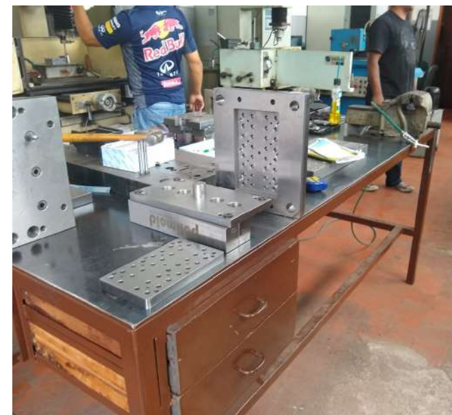
IMAGEM 5: Bancada de trabalho com morsa para serviços gerais. Em segundo plano, um trabalhador ajusta uma máquina de eletroerosão.
