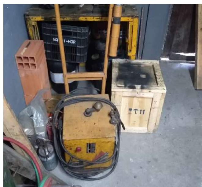
IMAGEM 7: Máquina de Solda Foto do Autor, 2019.
